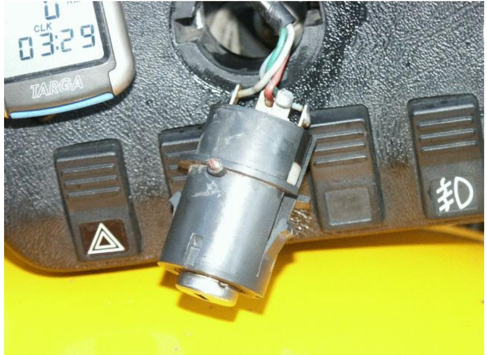
**An einer Seite sieht man eine kleine Bohrung die mit Lack verschmiert ist, darunter befindet sich eine kleine Schlitz-maden-schraube, diese legt man frei und schraubt sie heraus, dann kann man das Elektrikteil abziehen.**
