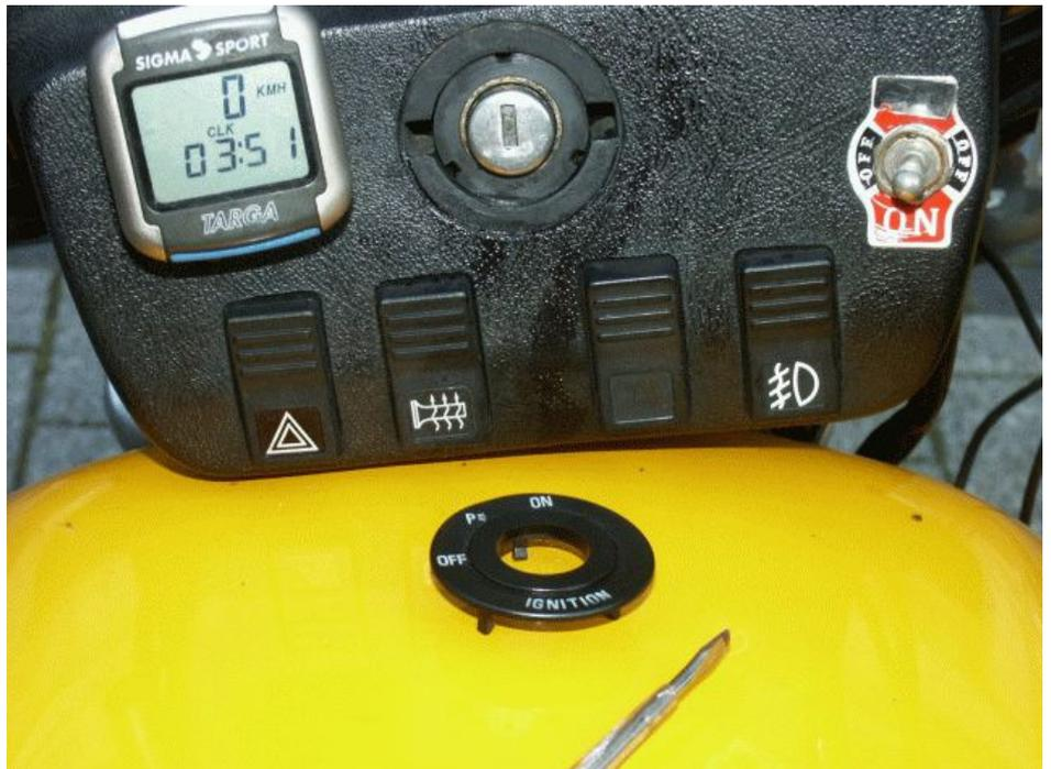
**Dann rechts und links mit einem kleinen Schraubendreher die Federzungen eindrücken und das Schloß gleichzeitig nach unten rausdrücken, schon hat man es in der Hand.**
