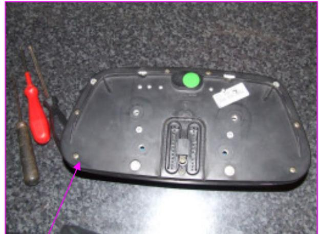
So sieht das Teil von innen aus, die komplette Platine wird von mind 6 Schrauben im Gehäuse befestigt, Augenmerk gilt den 4 Schrauben unten im Bereich der Steckerleisten, seitlich sollte man sich die Positionen merken, damit man beim Zusammenbau nicht in Konflikt mit den Gehäuseschrauben kommt.
