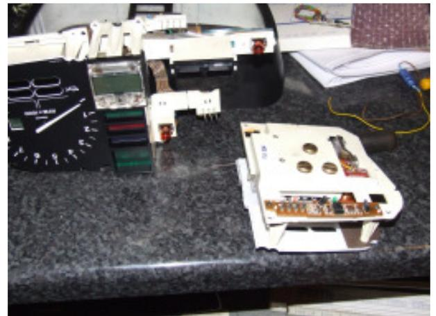
**So, in etwa habe ich den Kondensator eingelegt, an dieser Stelle klemmt er ganz leicht zwischen Platine und Gehäusesteg, Plusseite nach rechts, das ist normal dort wo eine Rundumeinkerbung anliegt.**
