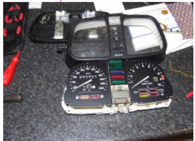
**Der eigentliche Tacho wird an der Grundplatine nur durch eine Schlitzschraube gehalten links neben der rechten Lampenfassung, rausdrehen, dann vorsichtig die Tachoeinheit vom Grundkörper abziehen, dabei auf die beiden Steckerleisten achten, eine unten im Bild erkennbar die zum Vorverstärker des Tachos führt, eine im oberen Bereich.**
