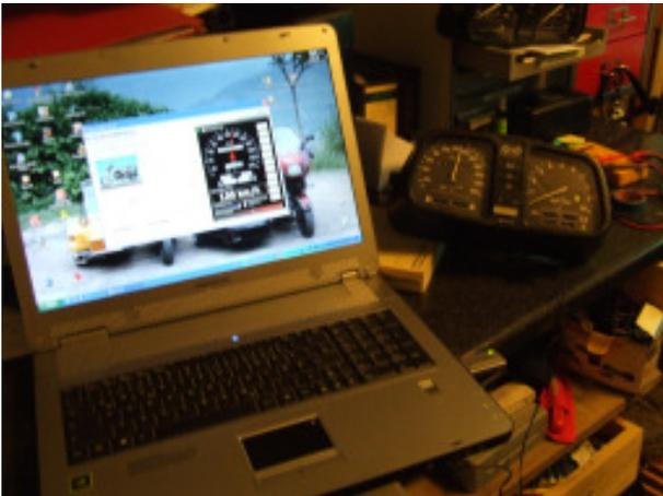
**Als letztes stand noch die Überprüfung des Tachos mittels der von Michael entworfenen Software an. Ich habe mir aus den 2 Steckern eines defekten Kabelbaums einen Adapter gebastelt, wo ich Pin 6 auf 12V gelegt habe, Pin 13 und 18 auf Masse, und Pin 22 + 23 auf einen Chinch-Adapter gelötet habe, daran gehe ich mit einem handelsüblichen Verbindungskabel von 3,5mm Stecker in den Lautsprecherausgang des Laptops und mit einem Kanal an den Chinch, der zweite bleibt frei.**
