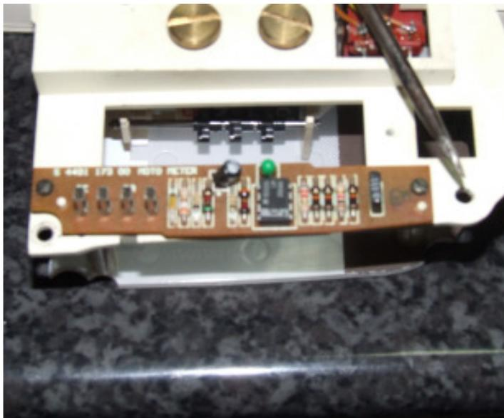
Die längliche Platine ist der Vorverstärker vom Tacho, dieser wird mit 2 Schlitzschrauben fixiert, lösen und abnehmen, da wir da dran rumlöten müssen. 😊😊
