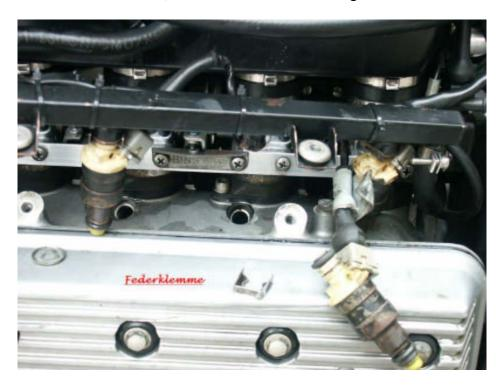
Die Montage der Leiste erfolgt, indem man die Leiste mit den Düsen vorsichtig in die Bohrungen setzt, eventuell vorher die O-Ringe leicht einfetten, dann die kpl. Leiste leicht eindrückt, und anschließen die beiden Schrauben wieder gleichmäßig festzieht.
