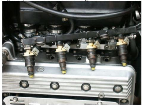
Zum Testen der Spritmenge kann man in dieser Lage die Anlage überprüfen, indem man die Leiste schräg hält und den Anlasser betätigt.
