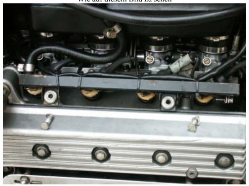
Dann hebele man die kpl. Einspritzleiste vorsichtig in Gegenrichtung der Einspritzdüsen, Diese sind nur gesteckt, vorher eventuell die Versenkungen der Düsen mit Druckluft reinigen.
